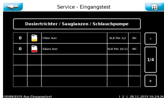
Der Eingangstest dient zur Überprüfung der angeschlossenen Eingänge (Schalter). Die wechselnde Betätigung der Schalter wird mit einer **0 (offen) bzw. 1 (geschlossen)** in Spalte angezeigt.
