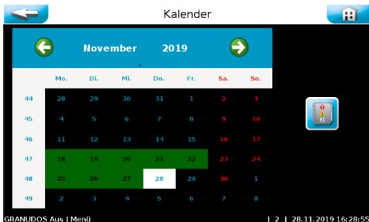
Der aktuelle Tag ist weiß hinterlegt. Tage in denen die Steuerung eingeschaltet war sind grün hinterlegt. Wird durch Antippen ein anderer Tag ausgewählt, so wird dieser Tag weiß hinterlegt. Mit dem Button **Event Log** werden die Ereignisse des ausgewählten Tages angezeigt.
