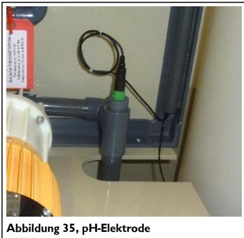
Abbildung 35, pH-Elektrode
