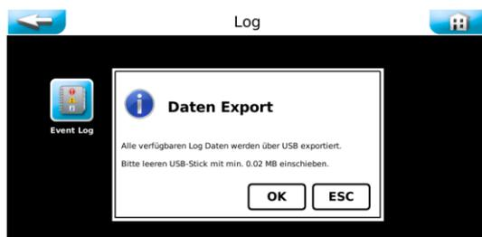
Unter dem Menüpunkt **Export** können die gespeicherten Log-Dateien auf einen **leeren USB-Stick** geladen werden. Falls der USB-Stick nicht leer ist, wird eine Formatierung vorgeschlagen und bei OK-Bestätigung durchgeführt.
